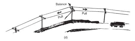
Figure 5-14. (d) Line making an angle.
