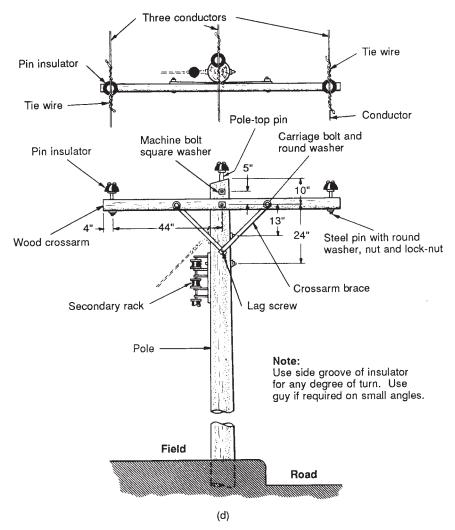
Figure 5-17. (d) Three-conductor pole head,  $0^{\circ}$  and small angles.
