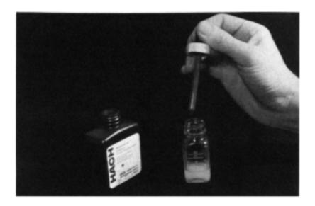
Figure 9.2 Titration using the Hach method.
